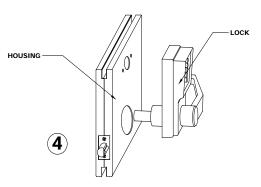
REMOVE LOCK BY SLIDING IT FROM THE HOUSING.
