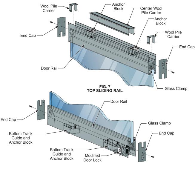
FIG. 8 BOTTOM SLIDING RAIL
