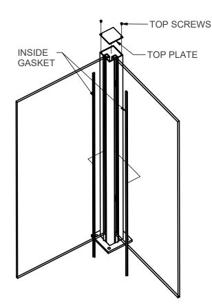
INSTALL INNER GLASS GASKET. DO NOT STRETCH GASKET. TRIM EXCESS GASKETS AT TOP OF POST. INSTALL TOP PLATE AND FASTEN WITH (2) SCREWS.
